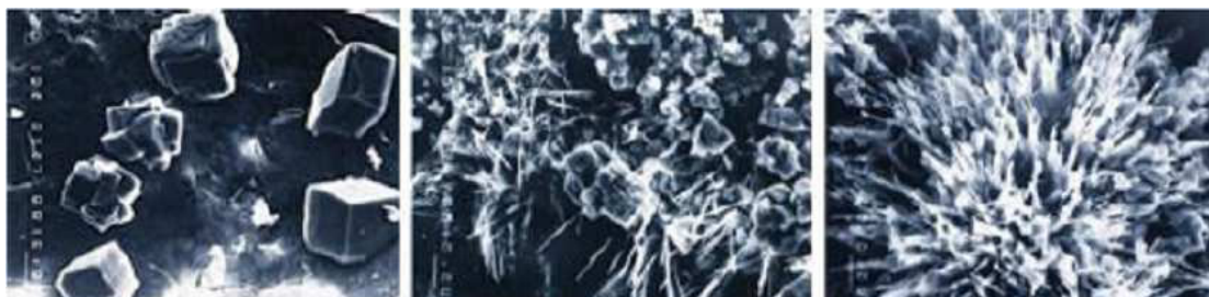
Obr. 2-6 Krystalizace přípravku xypex [5]
