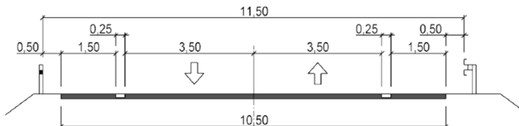
Obr.25 – Příčný řez komunikací S 11,5
