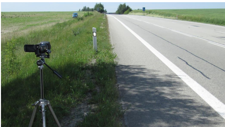
Obr.30 – Příklad umístění kamery na stanovišti na konci uspořádání 2+1 - silnice I/3 – Praha - Tábor
