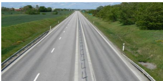
Obr.3 – Směrově dělená komunikace 2+1 pomocí lanového svodidla – Švédsko
