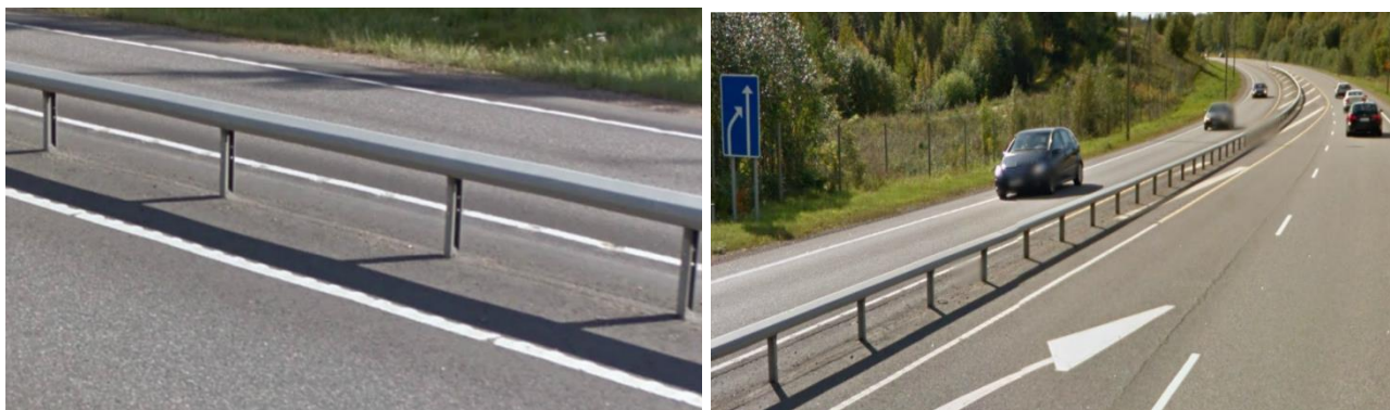
Obr.9 – Použití oddělení dopravních směrů záchytným bezpečnostním zařízením svodnicového typu
