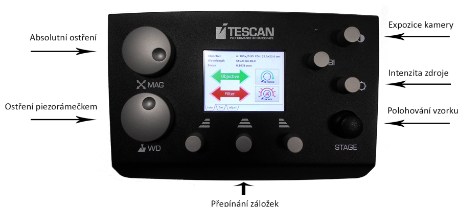
Obrázek 1.4: Ovladač holografického mikroskopu k jednodušší práci s mikroskopem.
