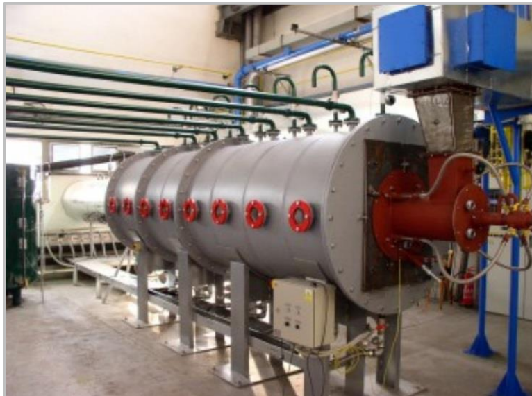
Obr. 3-3: Spalovací komora pro zkoušky hořáků na plynná a kapalná paliva [7].
