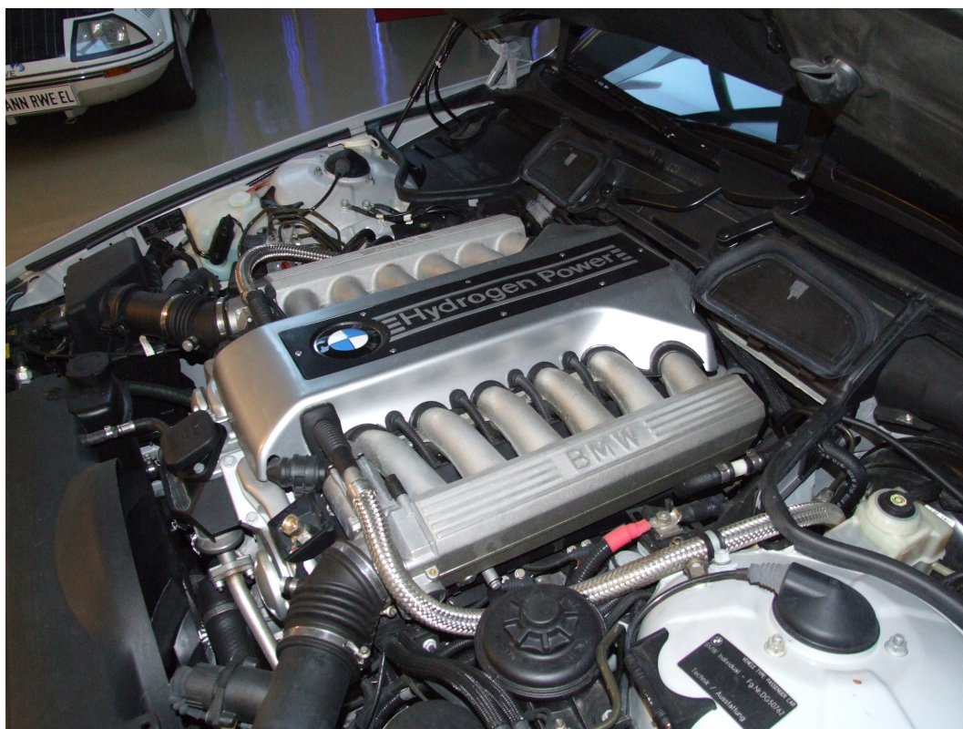
Obrázek 4.19: Motor pro BMW Hydrogen 7 [15]
