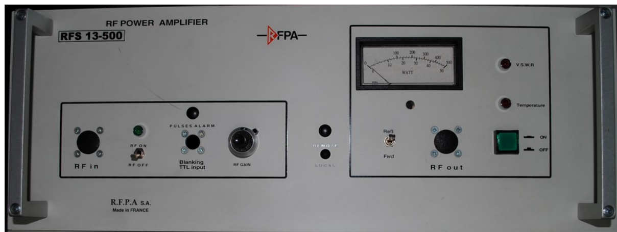
Obr. 4.11: 13,56 MHz RF zdroj „RFPA RFS 13-500“ na dodávanie výkonu do cievky budiacej plazmu.
