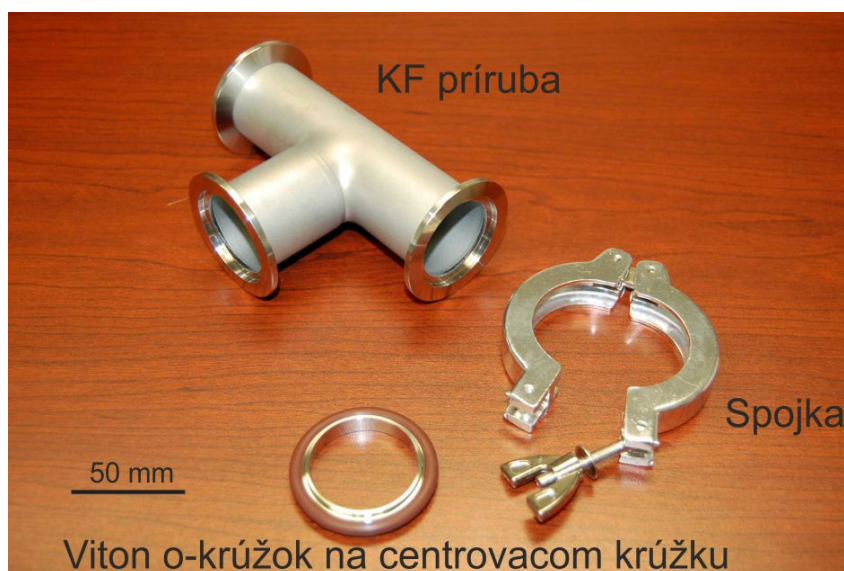
Obr. 4.1: KF systém spájania vákuových prírub. Prevzaté z [5].
