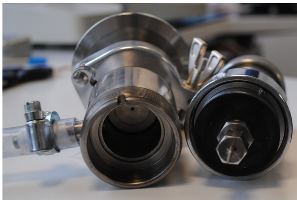
Obr. 4.9: Rozobratý ihlicový ventil použitý pri prvých experimentoch mal napojenie len na gumovú hadicu.
