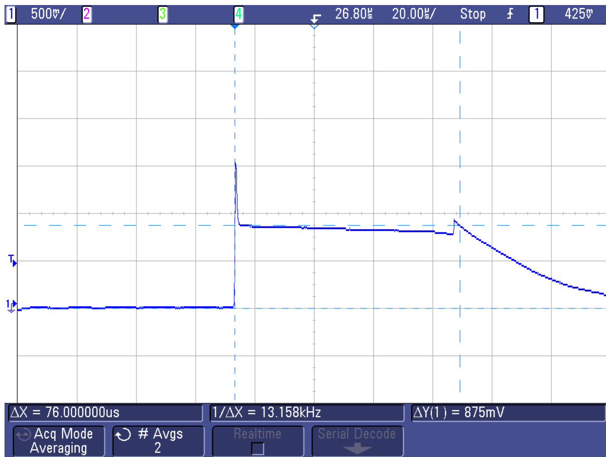
Obr. 3.9. – Změřený impuls z Geiger-Müller trubice na katodě
