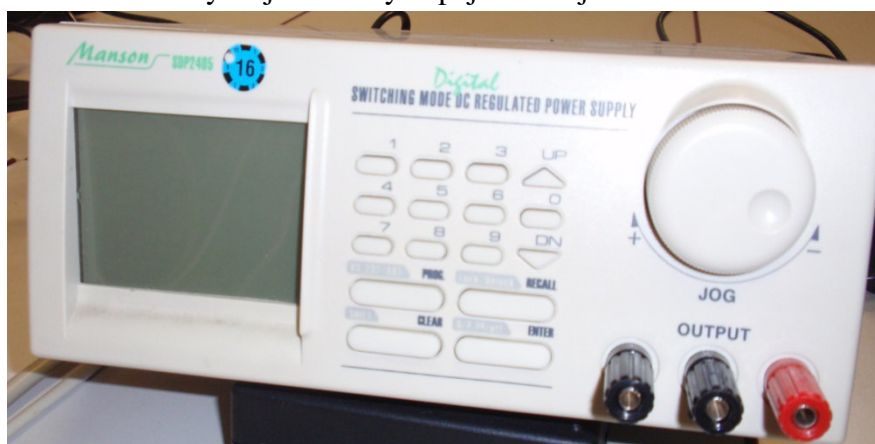
Nastavitelný stejnosměrný napájecí zdroj Manson SDP2405
