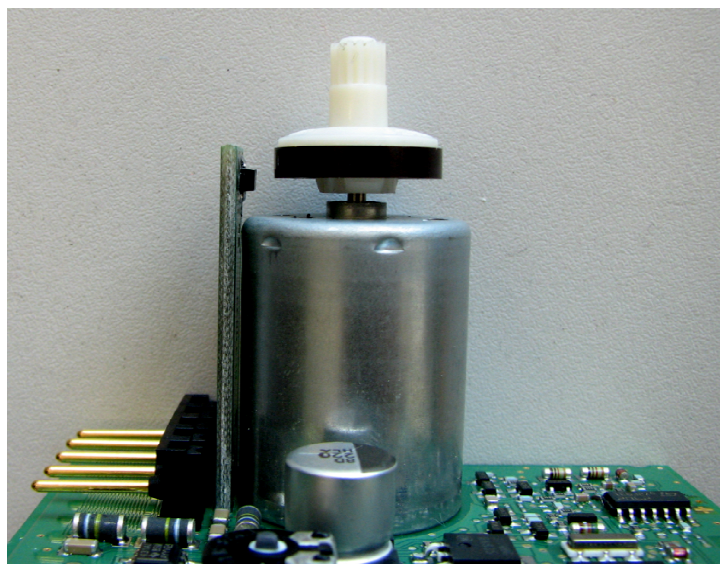
Obrázek 1.1.1: řídicí elektronika aktuátoru [zdroj vlastní]
