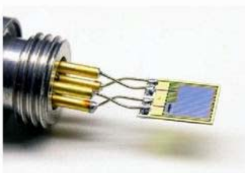
Obr. 2.3 Kapacitní senzor vlhkosti a teploty [13]
