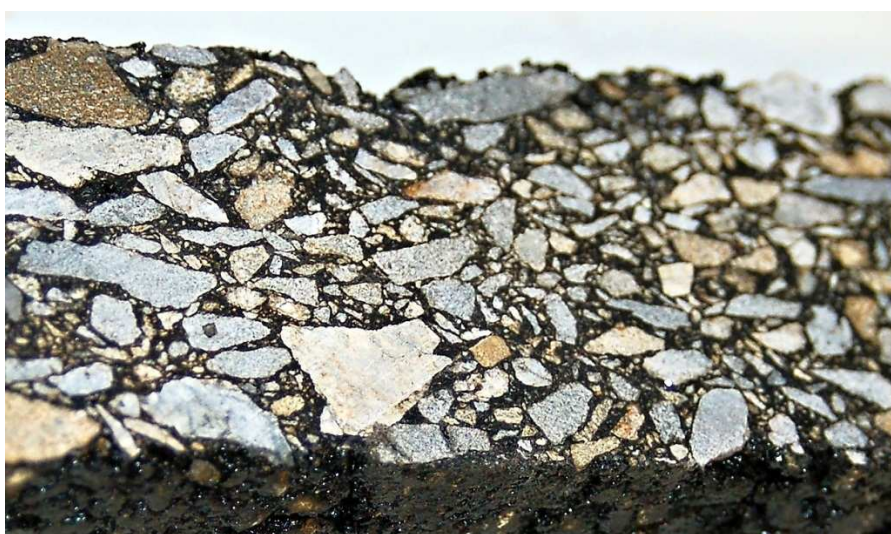
Obrázek 6: Asfaltový beton s plynulou zrnitostí
