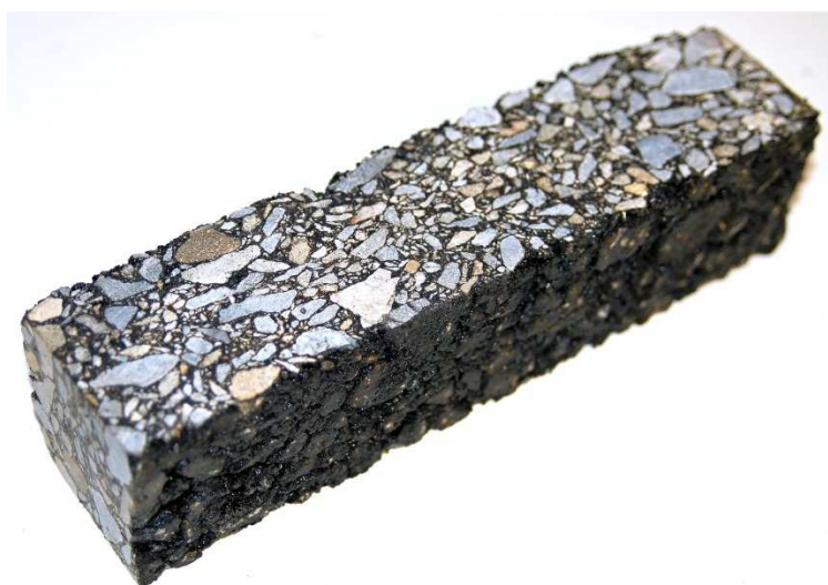
Obrázek 26: Zkušební trámeček pro stanovení nízkoteplotních charakteristik
