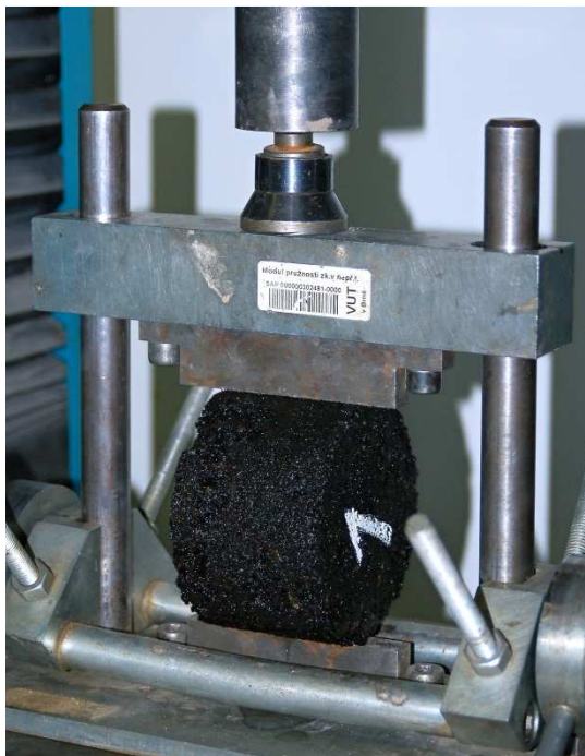
Obrázek 16: Měření příčného tahu na Marshallově tělese
