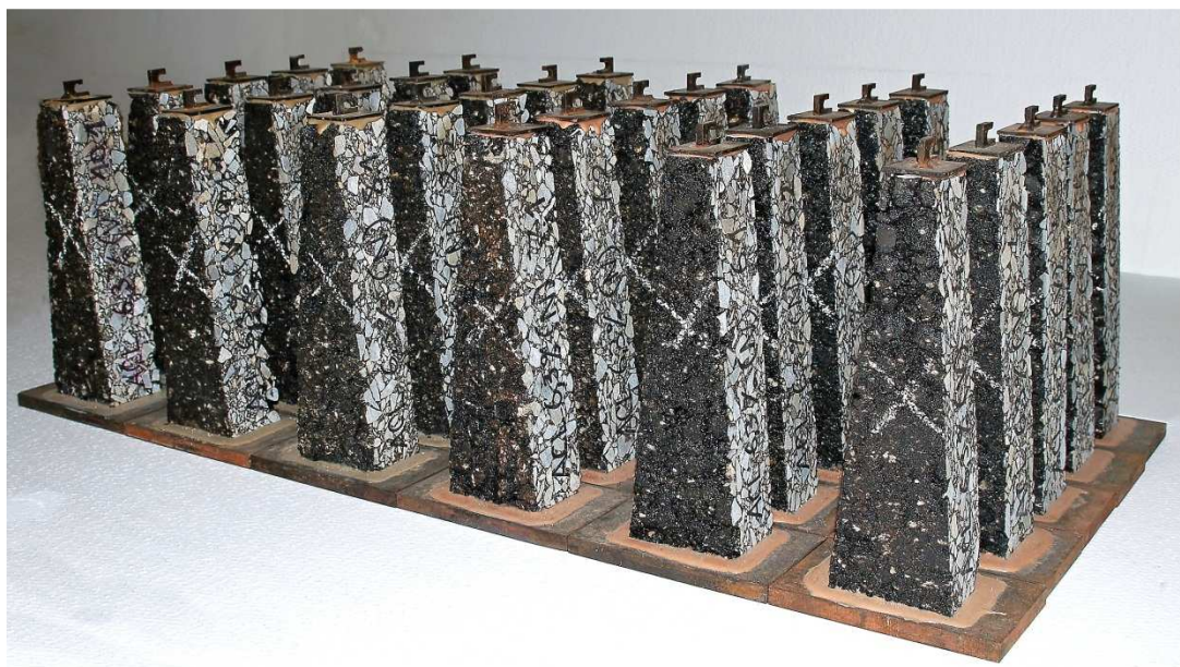
Obrázek 21: Zkušební tělesa - komolé klíny
