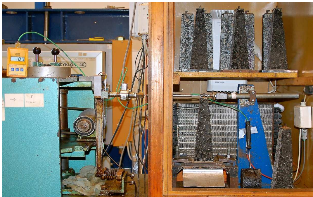
Obrázek 20: Zařízení pro měření modulů tuhosti asfaltových směsí
