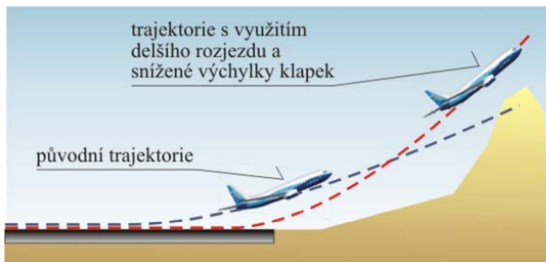
Obr.22 Zlepšení výkonu ve stoupání
