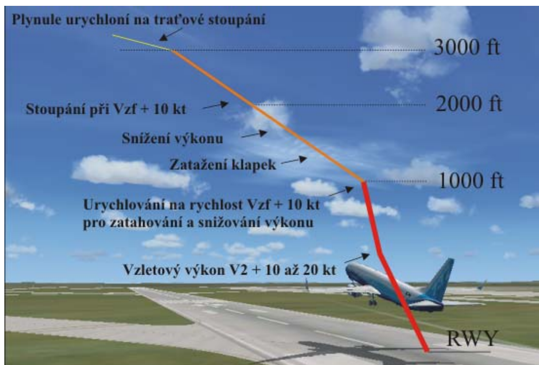
Obr.10 Postup B na snížení hluku v počáteční fázi vzletu
