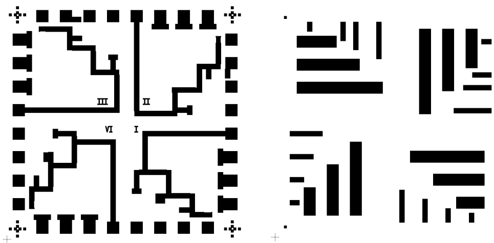
Obr. 18 Návrh vodivé a odporové vrstvy
