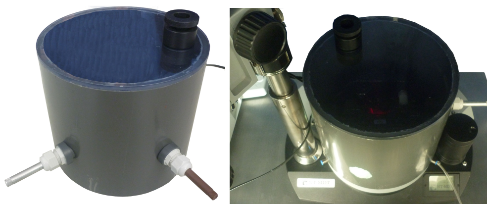
Obr. 4.3: Komora na regulaci vlhkosti samostatně a umístěna na AFM mikroskopu.
