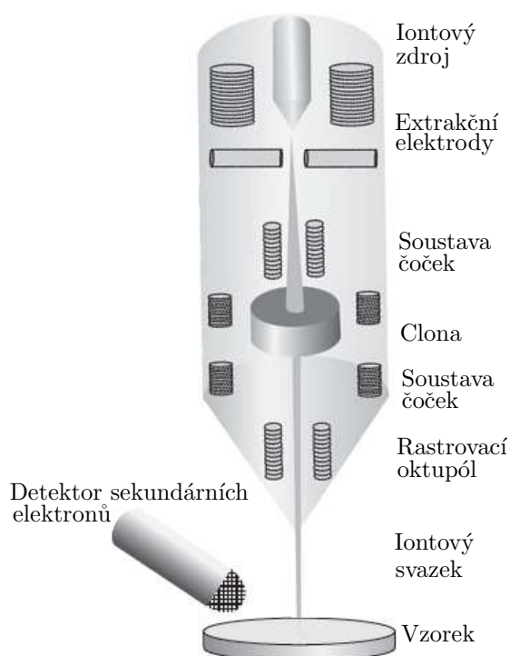
Obr. 3.1: Schéma aparatury pro metodu FIB; adaptováno z [30].
