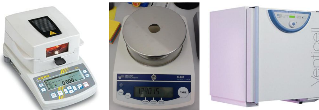
Obrázek 31: Sušící váhy (vlevo), laboratorní váhy (uprostřed) a laboratorní sušárna (vpravo)
