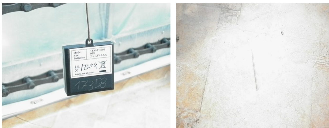
Obrázek 33: Senzor teploty a relativní vlhkosti (vlevo) a termočlánek (vpravo)
