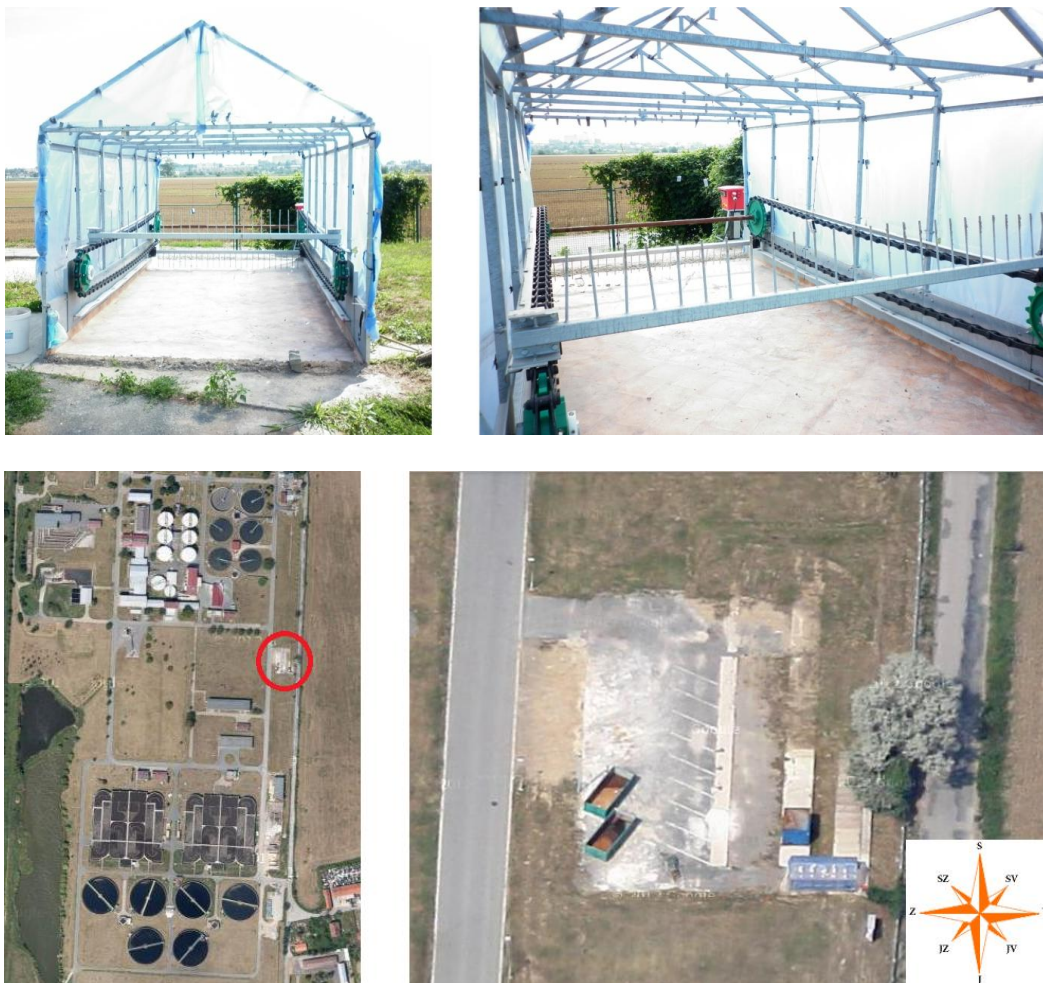
Obrázek 24: Experimentální solární sušárna (obrázky nahoře), umístění sušárny v areálu ČOV (obrázky dole, převzato z [19])
