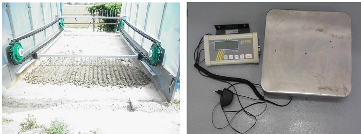
Obrázek 30: Nadávkovaný kal v sušící komoře (vlevo) a plošinové váhy na zvážení odvodněného kalu (vpravo)
