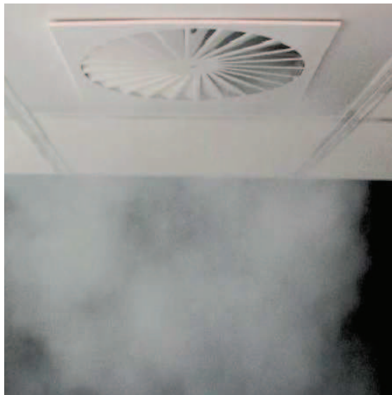
Obr. 8-1: Vertikální (teplý) proud [11]
