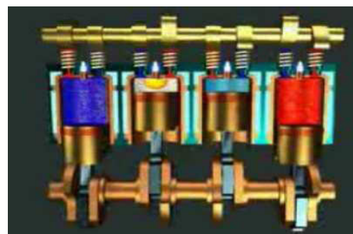
Obr.7 Ventilový rozvod OHC [15]
