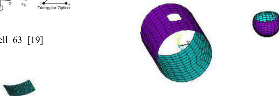
Obr.99 Vysítování kontaktních ploch ventilového vahadla pomocným prvkem Shell 63
