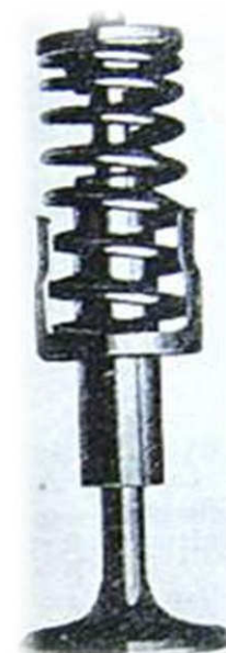
Obr.34 Třecí tlumič kmitů ventilové pružiny [13]
