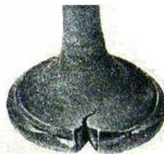
Obr.24 Porucha na ventilu způsobená tím, že se odloupkla část vrstvy karbonu na sedle [12]
