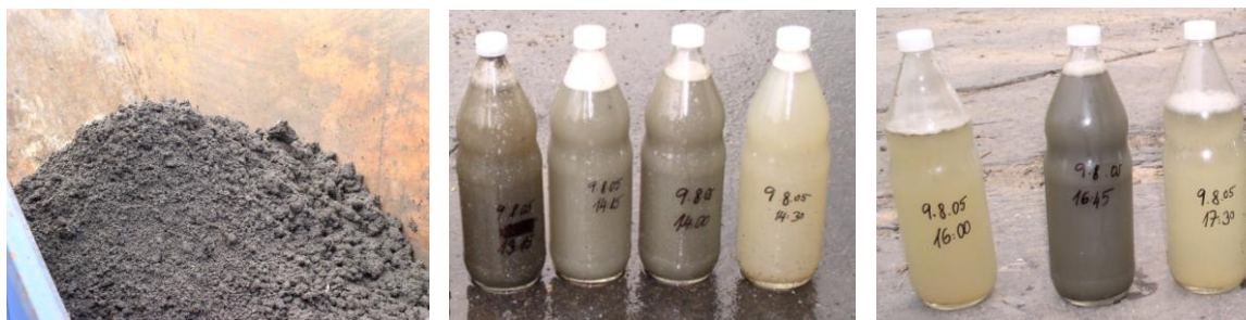
Obr. 21 Vzhled odvodněného kalu a fugátu s použitím flokulantů VTA F 096 MHW a F 098 MHW
