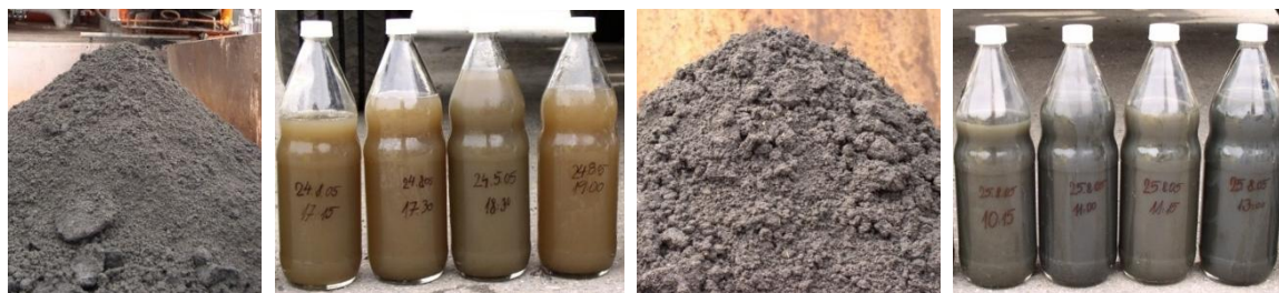
Obr. 22 Vzhled odvodněného kalu a fugátu s použitím flokulantu Sokoflok 68 (vlevo) a VTA (vpravo)
