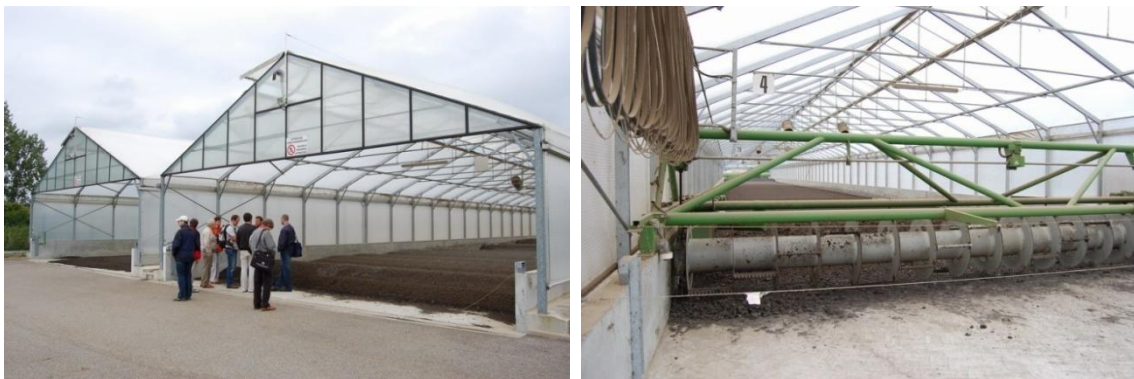
Obr. 10 Solární sušárna Brumath, Francie (vlevo celkový pohled na haly, vpravo pohled na přehrabovací zařízení)
