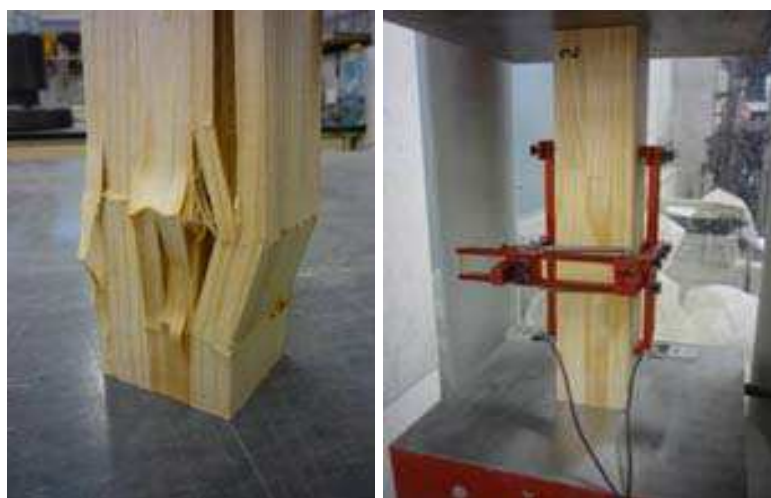
Obr. 24 – Zkouška pevnosti lamelového dřeva v tlaku. [13]
