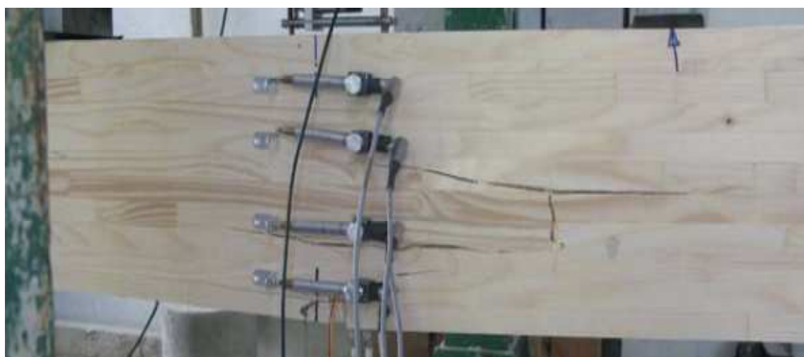
Obr. 30 – Porušení nosníku LL03. [13]
