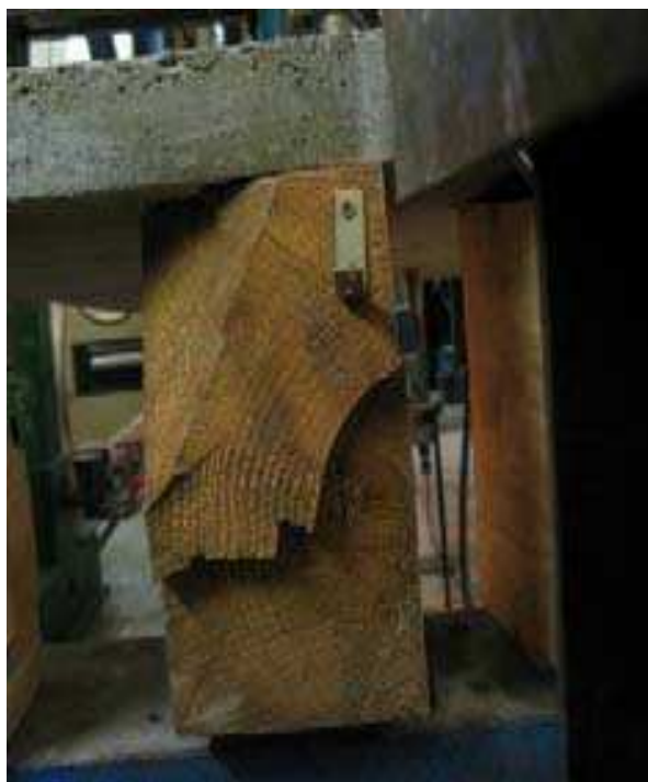
Obr.42 – Vznik podélné trhliny pod koncem hřebíků. [14]
