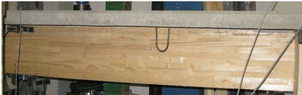
Obr. 34 Lepený nosník s nadbetonávkou. [14]
