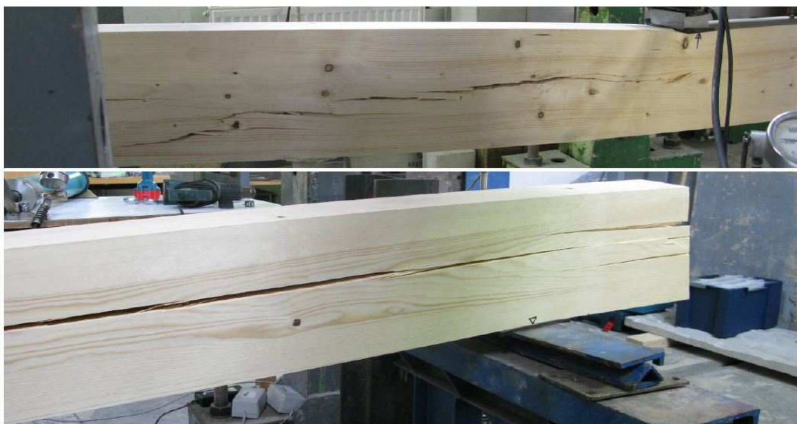
Obr. 32 – Porušení nosníku R01. [13]
