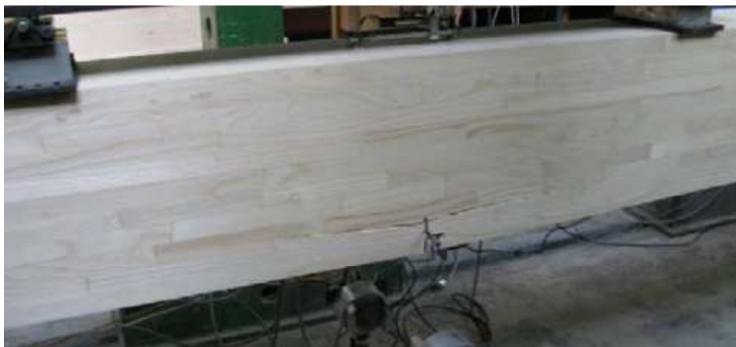
Obr. 29 – Porušení nosníku LL02. [13]
