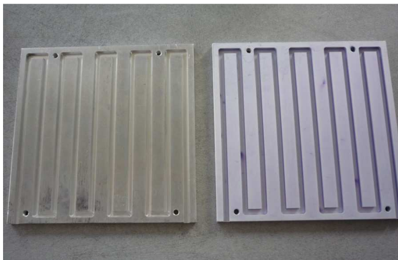
Obr. 27: Vlevo je opracovaná hliníková destička a vpravo je hliníková destička po anodizaci hliníku (eloxování)
