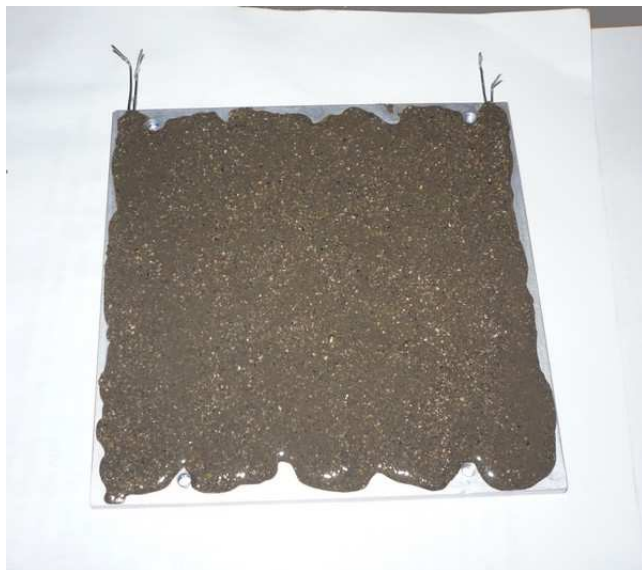
Obr. 30: Vytvořené topné těleso po upevnění odporového drátu
