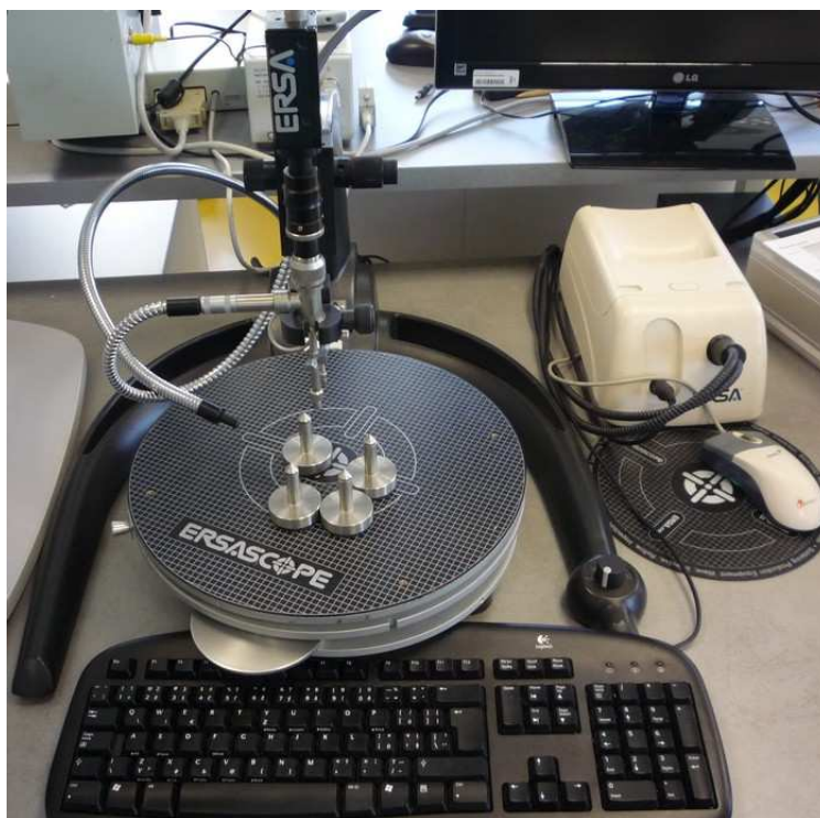
Obr. 24: ERSASCOPE - systém pro kontrolu špatně dostupných míst na DPS pomocí mikrokamery
