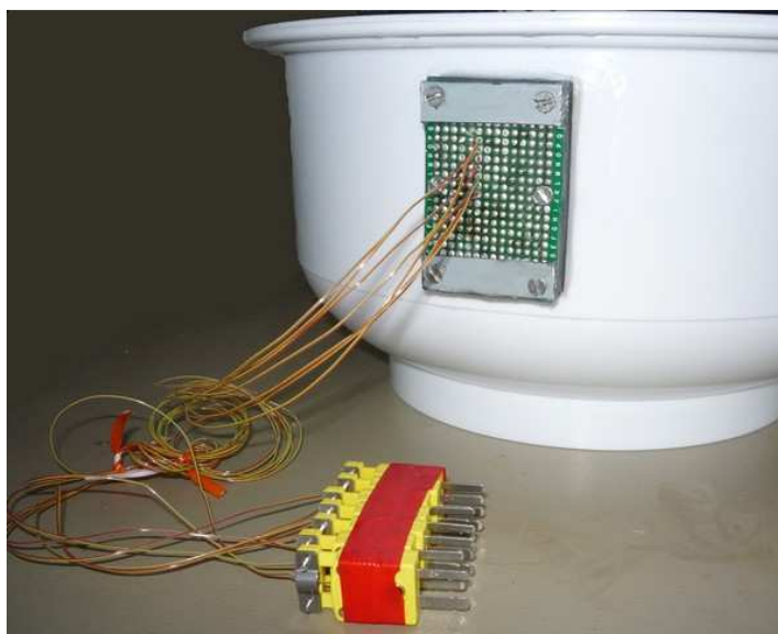
Obr. 26: Termočláňkové pole se sedmi termočláňky typu K
