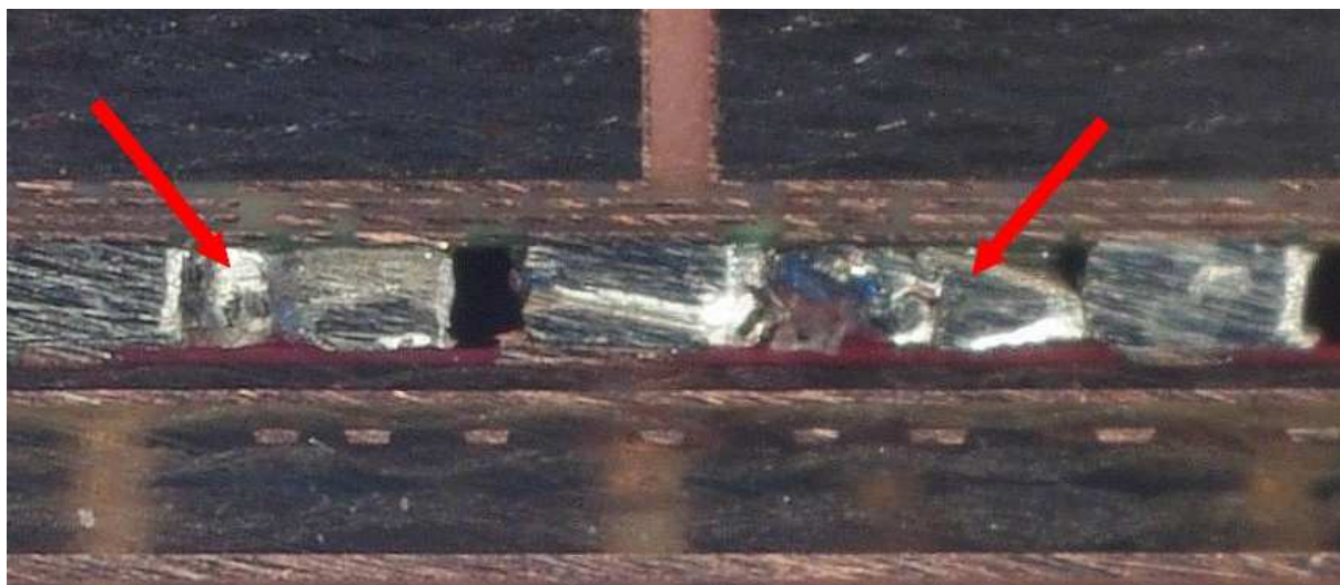
Obr. 61: Zkrat způsobený pájkovou kuličkou, která nezůstala na svém místě při pájení (GPU ATI)
