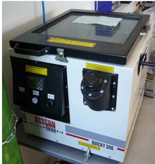
Obr. 48: Zařízení QUICKY 300 sloužící pro pájení v parách
