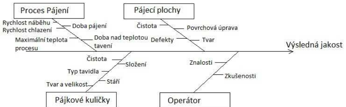
Obr. 16: Diagram s činiteli ovlivňujícími jakost zapájení pouzder BGA
