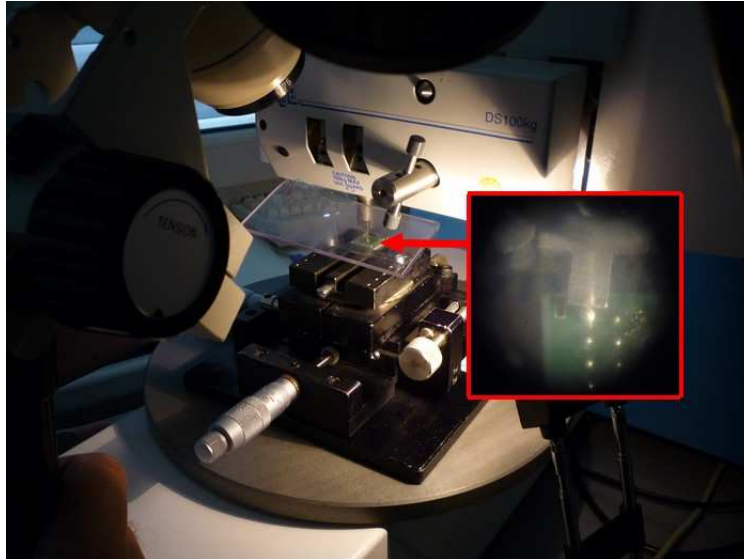
Obr. 51: Zařízení DAGE 2400 s detailem na trhací nástroj a pájkovou kuličku
