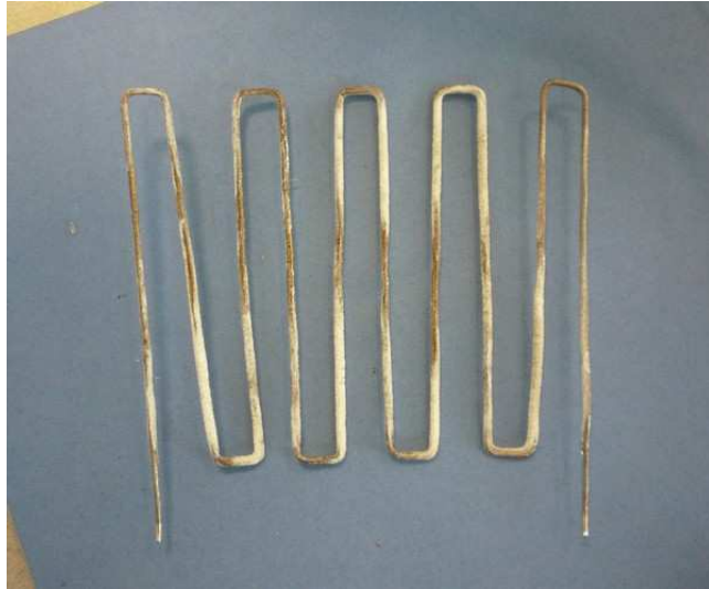
Obr. 29: Odporový drát izolovaný skleněnými mikrokuličkami (balotinou)
