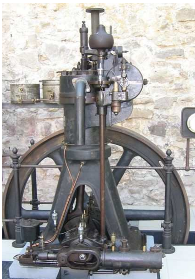
Obr. 2.1 - Stacionární diesel MAN z roku 1906, výkon 12 HP [7]
