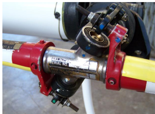
Obr. 6.4 Dvoulistý ocasní rotor Schweizeru 300 CB [136]
