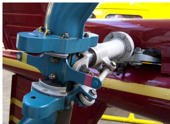
Obr. 6.5 Ocasní rotor s pružnými členy vrtulníku AS 355 F2 [136]
