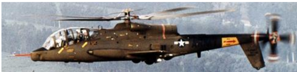
Obr. 6.2 Příklad vrtulníků se čtyřlístým tuhým ocasním rotorem - AH - 56 Cheyenne [I34]
