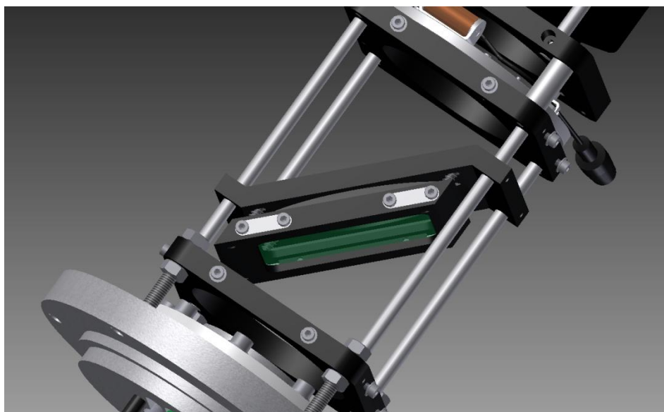
Obr. 3.17: Konštrukčný návrh dielektrického zrkadla
