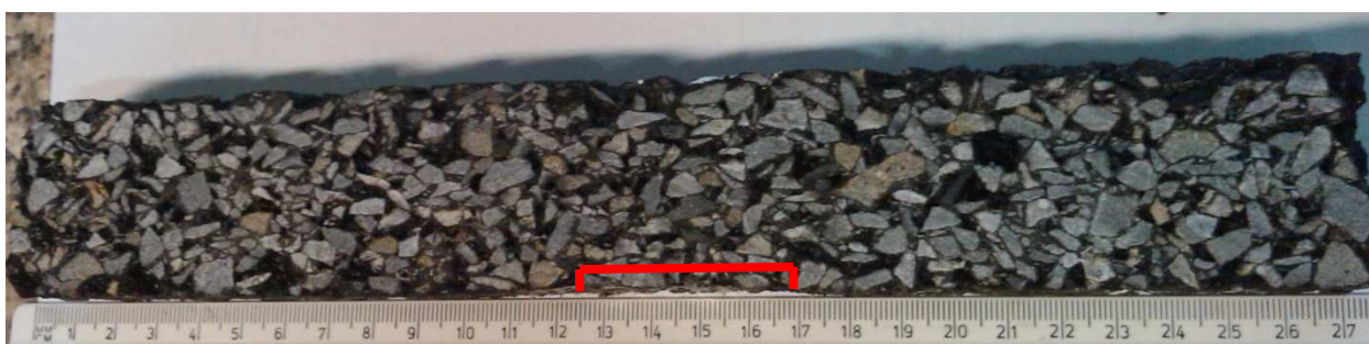
Obrázek 6.1: Záznam vyjeté koleje pro směs PA 8
