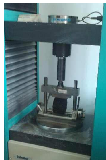
Obrázek 5.6: Přístroj na měření příčného tahu (upravený lis)
