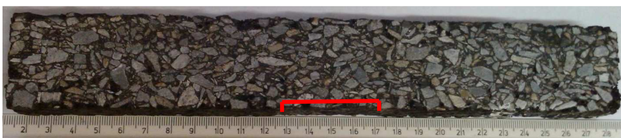
Obrázek 6.2: Záznam vyjeté koleje pro směs BBTM 8
