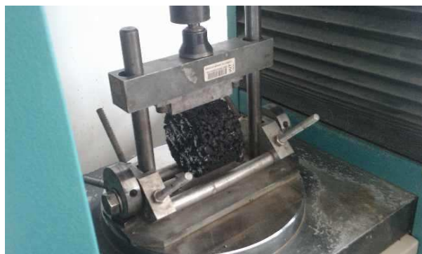
Obrázek 5.5: Nastavovací rám na zkoušku s již uchyceným tělesem
