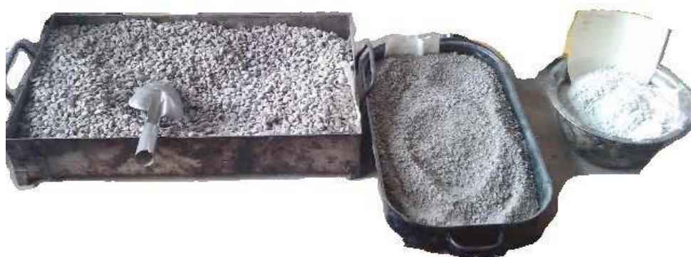
Obrázek 2.1: Použitá kameniva (vlevo 4 - 8, uprostřed 0 - 4, vpravo filer)
