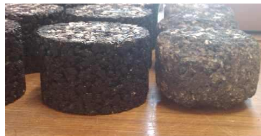
Obrázek 5.9: Porovnání těles před a po (vpravo) zkoušce
