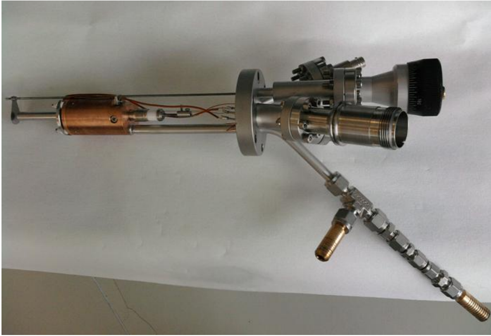
Obr. 13: Fotografie sestavené efuzní cely poskytující atomární svazky křemíku.
