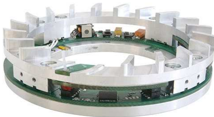
Obr. 13 Bezdrátový monitorovací systém hlídající teplotu ložisek [8]
