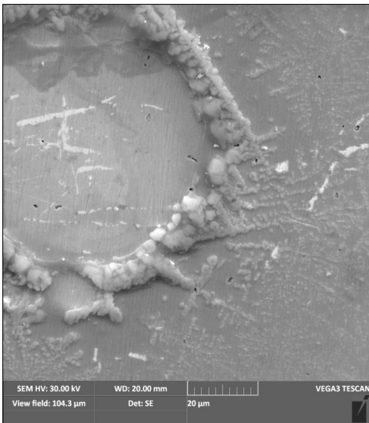
Obr. 8.3.2 Detail povrchového kráteru po molekule vodíku. 41
