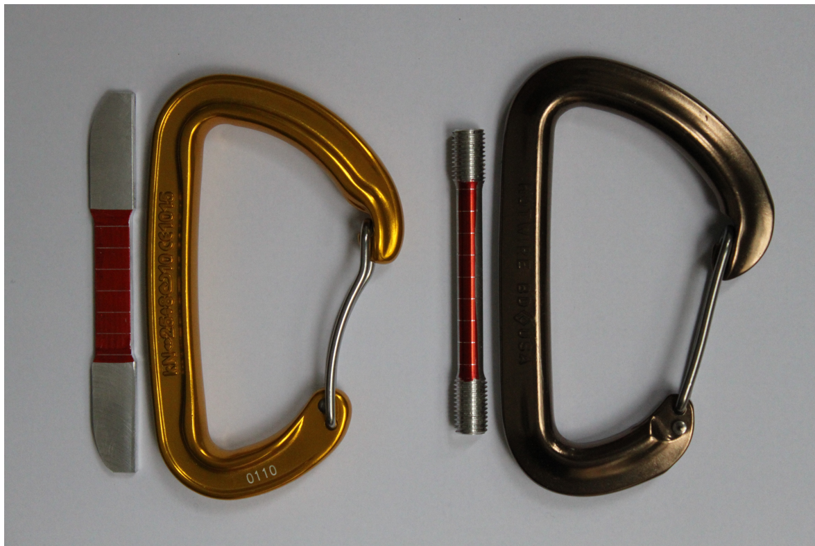
Obr. 15: Karabiny a zkušební tělesa pro zkoušku tahem
