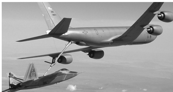
Obr.2.4. Ukázka tankování paliva za letu, [4]
