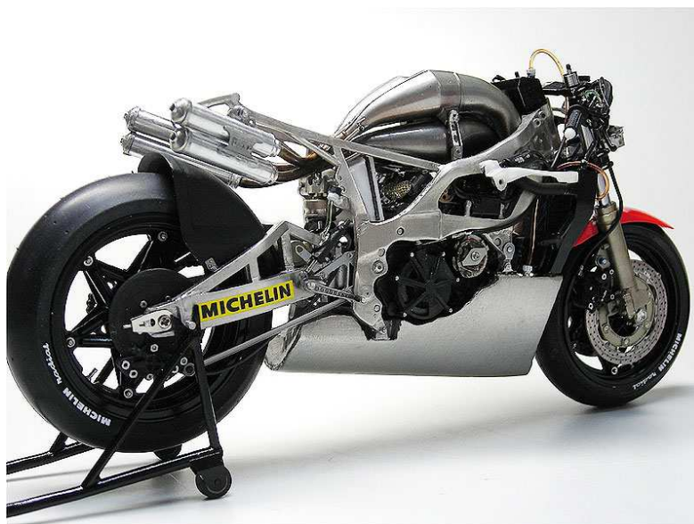
Obr. 46: Umístění výfukové soustavy místo nádrže u Hondy NSR 500 1984 [30]
