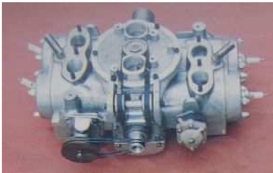
Obr. 14: Čtyřválec typu boxer německé firmy König s řemenovým pohonem šoupátka [17]
