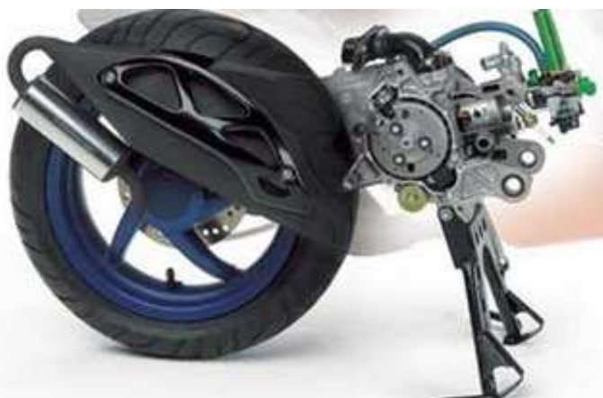
Obr. 7: Sestava pohonné jednotky skútru Aprilia SR50 DiTech [14]
