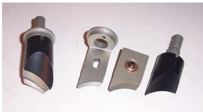
Obr. 30: Trojdílná výfuková přívěra Suzuki Super AETC z motoru Suzuki RGV 250 Gamma [22]
