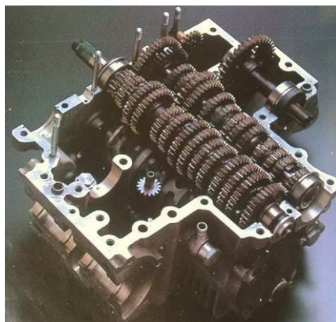
Obr. 34: Detail 14-tistupňové převodovky Suzuki 50 RP68 [24]
