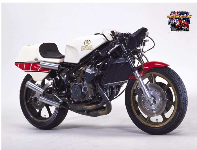
Obr. 41: YZR500 OW35K s řadovým čtyřválcem a systémem YPVS, bez kapotáže [29]
