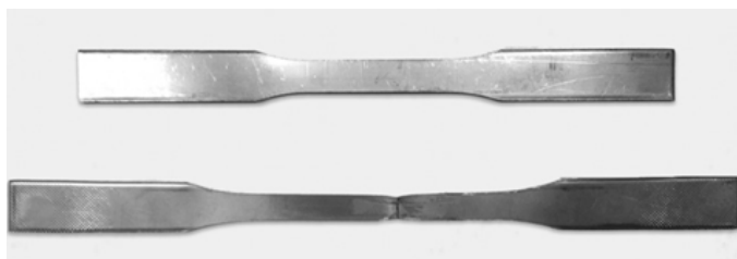
Obr. 2.6: Vzorek z tahové zkoušky před a po testu [8]
