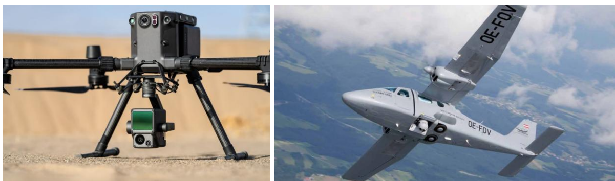
Obrázek 31 Vlevo dron DJI Matrice 300 RTK s kamerou LiDAR DJI Zenmuse L1 a vpravo letoun Tecnam P20006T vybaven rakouským laserovým skenerem LMS-Q680i [24] [29]
