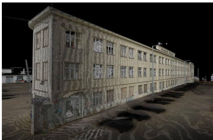
Obrázek 29 Vlevo statický skener Faro Focus Premium, vpravo výstup mračna bodů ze statického skeneru budovy bývalého filmového studia v Hostivaři [24] [28]
