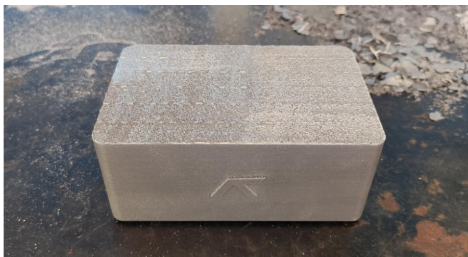
Obr. 13-12 Díl s odstraněnými stavebními podporami
