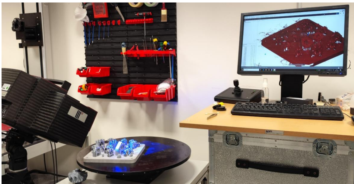
Obr. 4-14 3D skenování vyrobených vzorků navržených struktur
