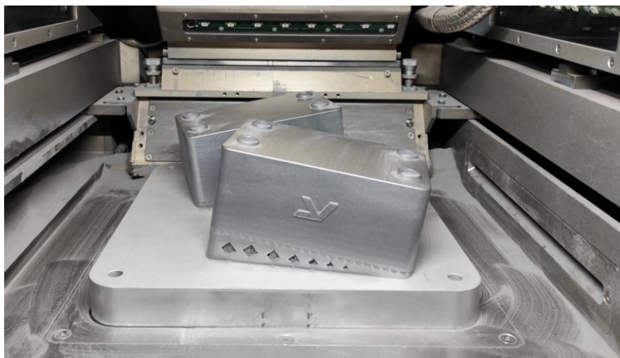
Obr. 13-10 Odstranění přebytečného prášku ze stavební komory stroje
