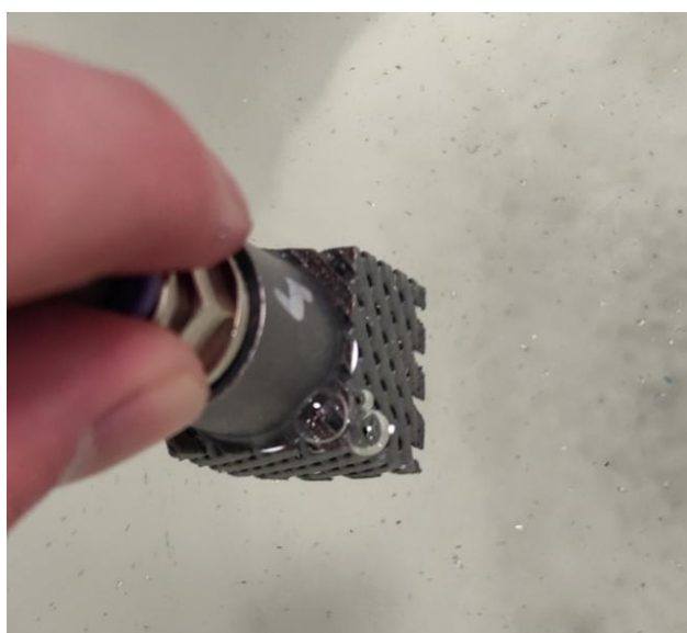
Obr. 6-8 Tlakování vzorků (vlevo) a vadný netěsnící vzorek (vpravo)
