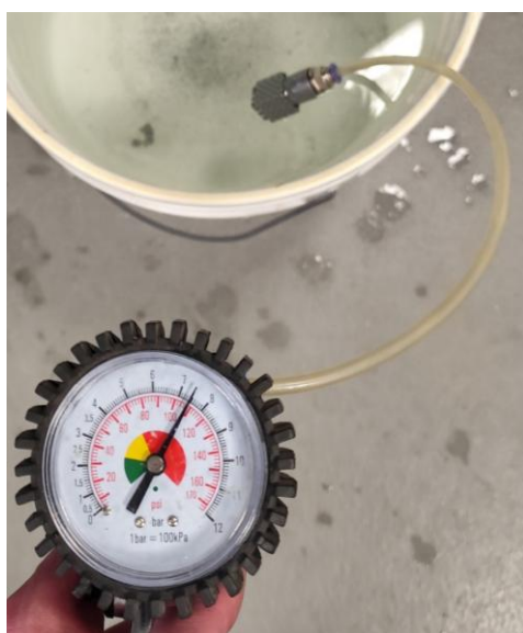
Obr. 6-8 Tlakování vzorků (vlevo) a vadný netěsnící vzorek (vpravo)
