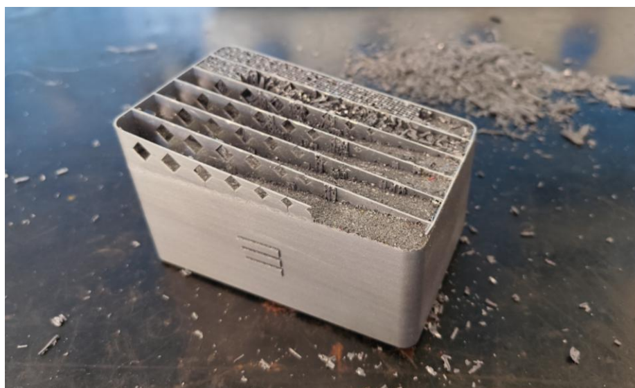
Obr. 13-11 Průběh odstranění stavebních podpor
