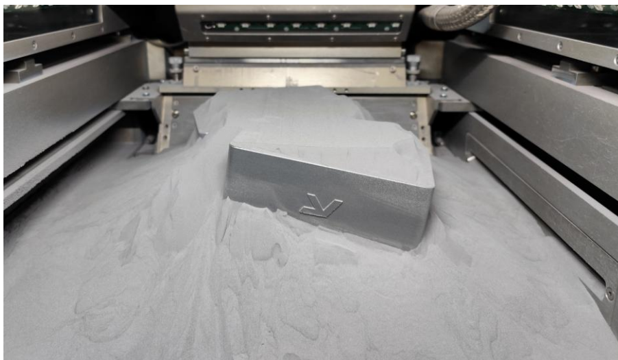
Obr. 13-9 Díly ve stavební komoře po dokončení výroby technologií LPBF
