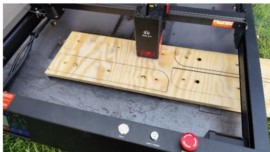
Obr. 40 Vypalování dílců z překližky.
