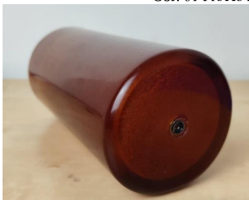
Obr. 62 Výsledné polyuretanové jádro.
