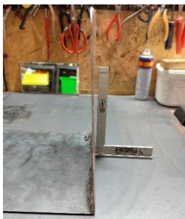
Obr. 45 První fáze nepovedeného sváření dílců.
