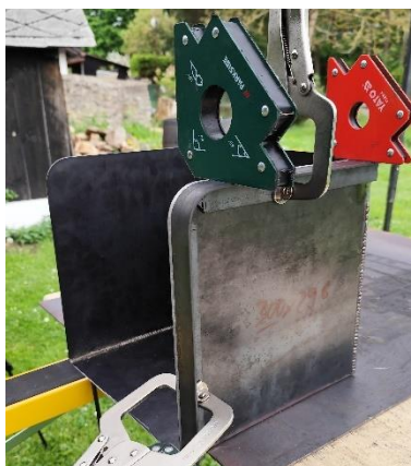
Obr. 47 Vymezení a upevnění L profilu.
