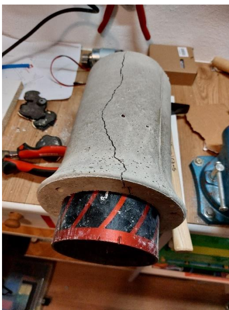
Obr. 55 Neúspěšné odformování odlitku.
