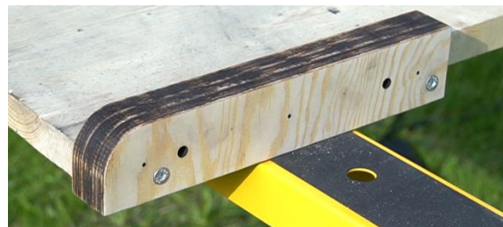
Obr. 41 Přípravek pro ohnutí L profilů.
