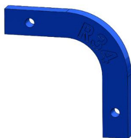
Obr. 39 Šablona pro tvorbu rádiusu plechového dílce.
