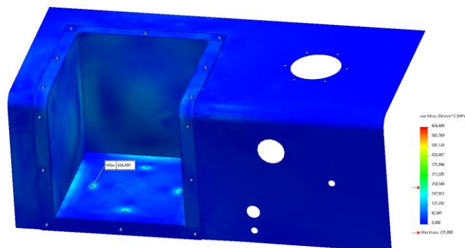
Obr. 15 Kritické místo napětí těla komory 1. iterace analýzy.
