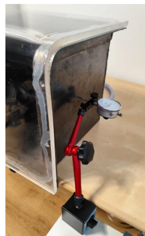
Obr. 72 Testování průhybu těla komory.
