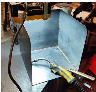
Obr. 46 Svařené rovinné dílce přípravné komory.
