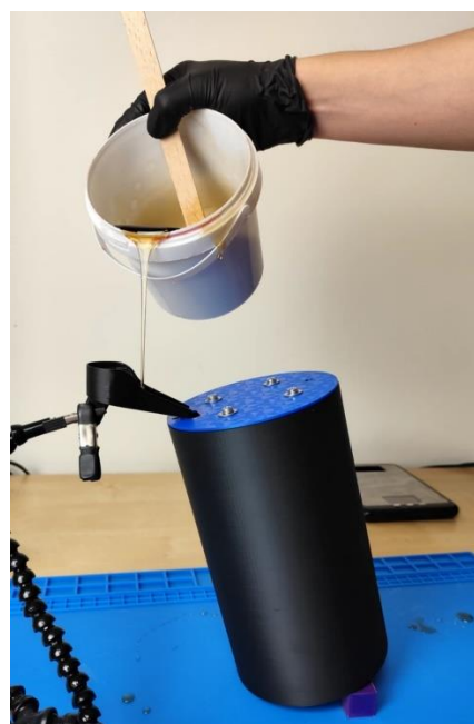
Obr. 61 Proces lití polyuretanového jádra.
