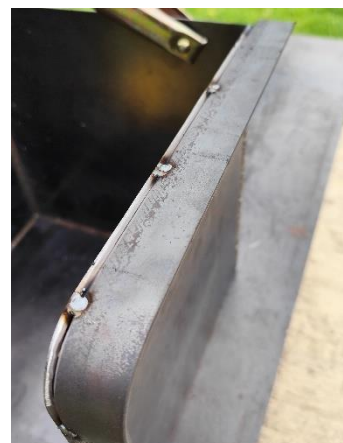
Obr. 48 Bodové ustanovení L profilu.
