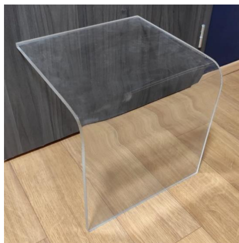
Obr. 51 Vyrobené PMMA víko.
