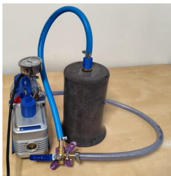
Obr. 73 Testování licí komory.
