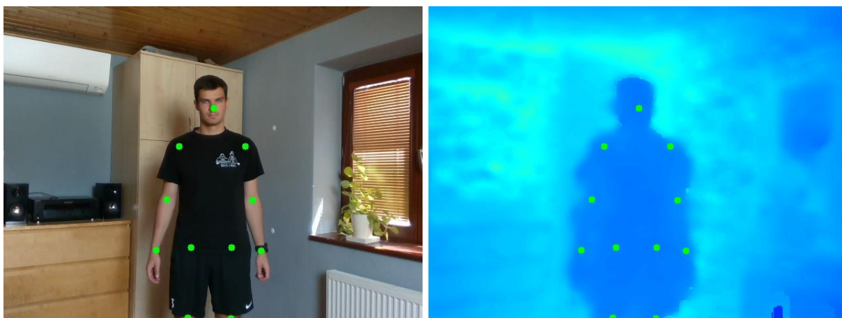
Obr. 3.7: RGB a hloubkový snímek s detekovanými klíčovými body osoby pomocí knihovny MediaPipe.
