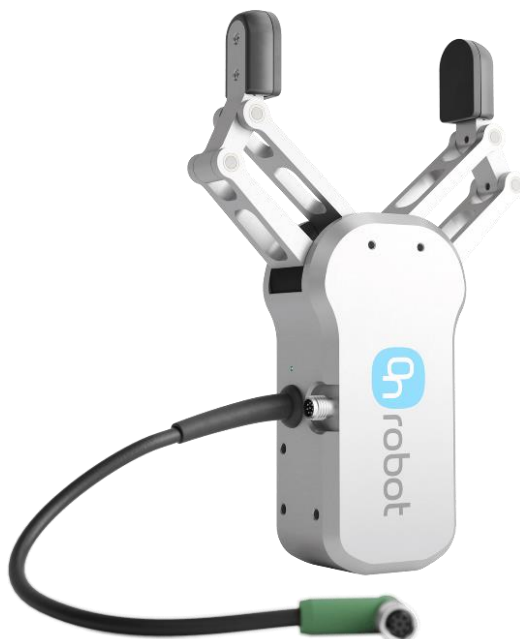
Obr. 3.11: OnRobot RG2 gripper použitý jako koncový efektor robota UR5e.
