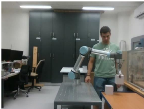
Obr. 3.18: Situace, kdy chybná detekce osoby způsobila vytvoření falešné překážky a přerušení pohybu robota.
