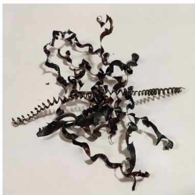
Obr. 32 Třísky dlouhé z nástrojárny (stužkově smotané)
