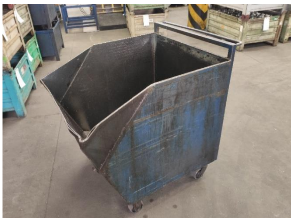
Obr. 20 Vozík na třísky o objemu 1 m 3
