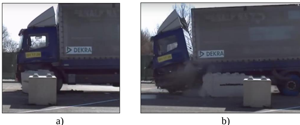
Obr. 4 Priebeh nárazu do betónového bloku: a) tesne po zrážke, b) prerazenie [12]
