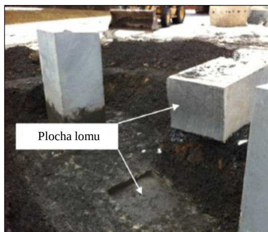
Obr. 5 Bariéra z čiernych balvanov po teste [13]
