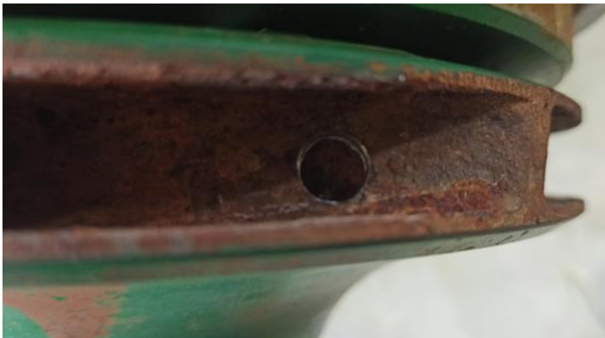
Obrázek 3-3: Uměle vytvořená vada na čerpadle [29]
