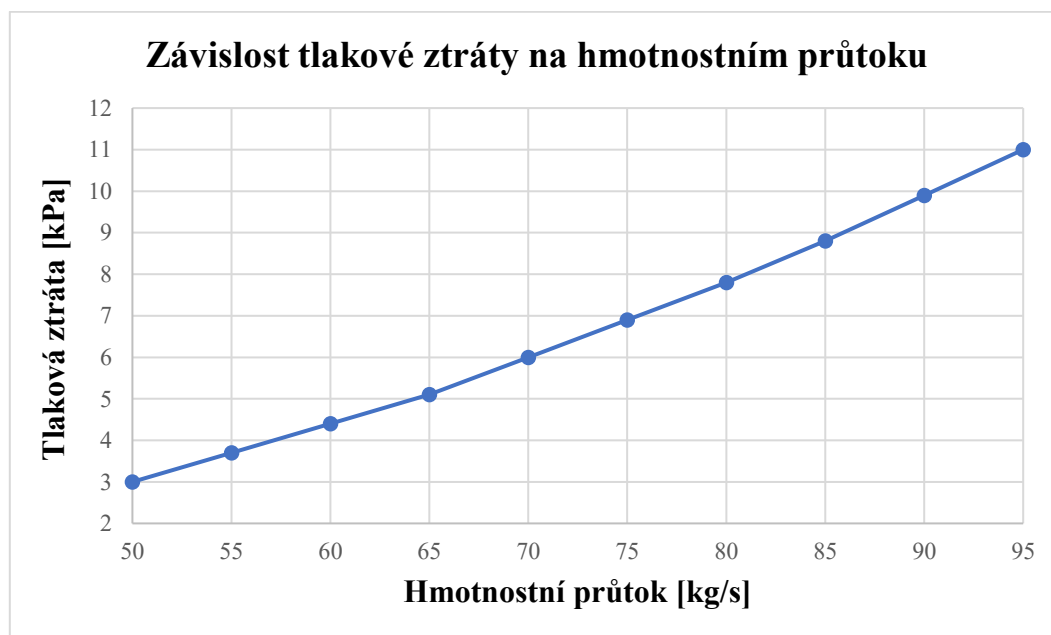
Obr. 7.2 Závislost tlakové ztráty na hmotnostním průtoku
