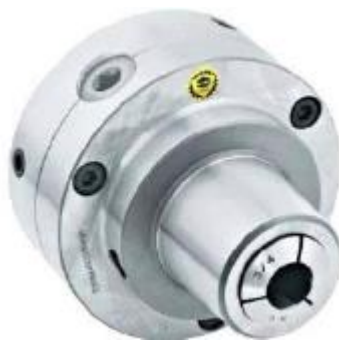
Obr. 24) Kleština – zařízení pro upínání obrobku při soustružení [13]
