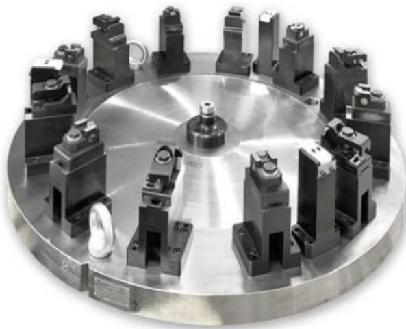
Obr. 25) Speciální upínací přípravek pro soustružení dílců leteckého motoru [23]
