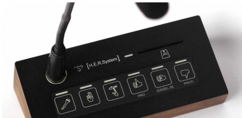
Obr. 2.2: Hlasovacie zariadenie H.E.R. Systému 9 obsahujúce tlačidlá pre zvolenie hlasovacej možnosti (pre, proti, zdržal sa) a tlačidlá pre zapnutie mikrofónu, žiadosť o slovo či technickú poznámku.
