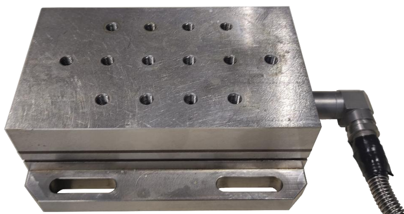
Obr. 15 Dynamometr Kistler 9257B pro měření silového zatížení ve třech osách.
