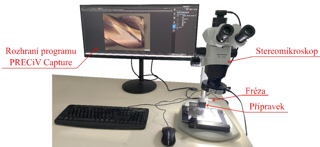
Obr. 33 Proces měření opotřebení nástrojů pomocí mikroskopu Olympus SZX10.
