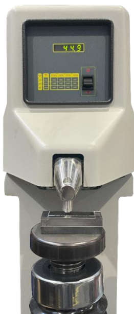
Obr. 31 Proces měření tvrdosti pomocí tvrdoměru ZwickRoell.
