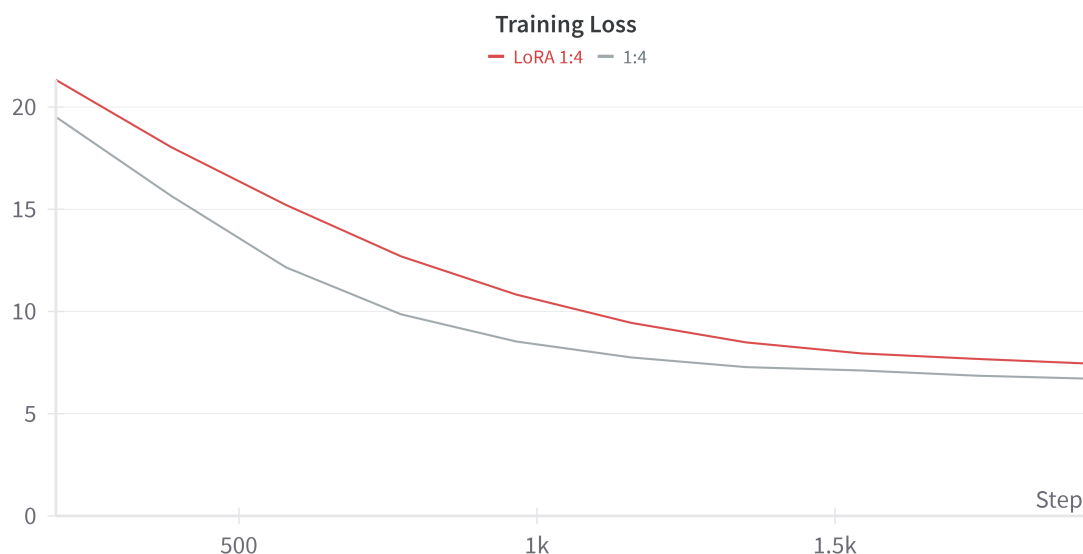
Obr. 8.15: Porovnanie priebehu chybovej funkcie pri trénovaní s použitím techniky LoRA a selektívneho zmrazenia modulov. Grafy ukazujú podobný priebeh konvergencie pre oba prístupy pri pomere nových a pôvodných dát 1:4.
