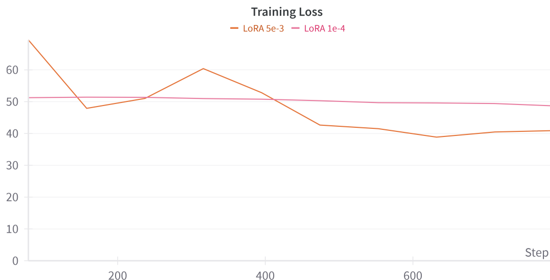
Obr. 8.11: Chybová funkcia po aplikovaní LoRA modulov len na Query a Value časti siete OneFormer. Model sa neučil pri malej rýchlosti učenia nič, a pri väčších nastala explózia gradientov.
