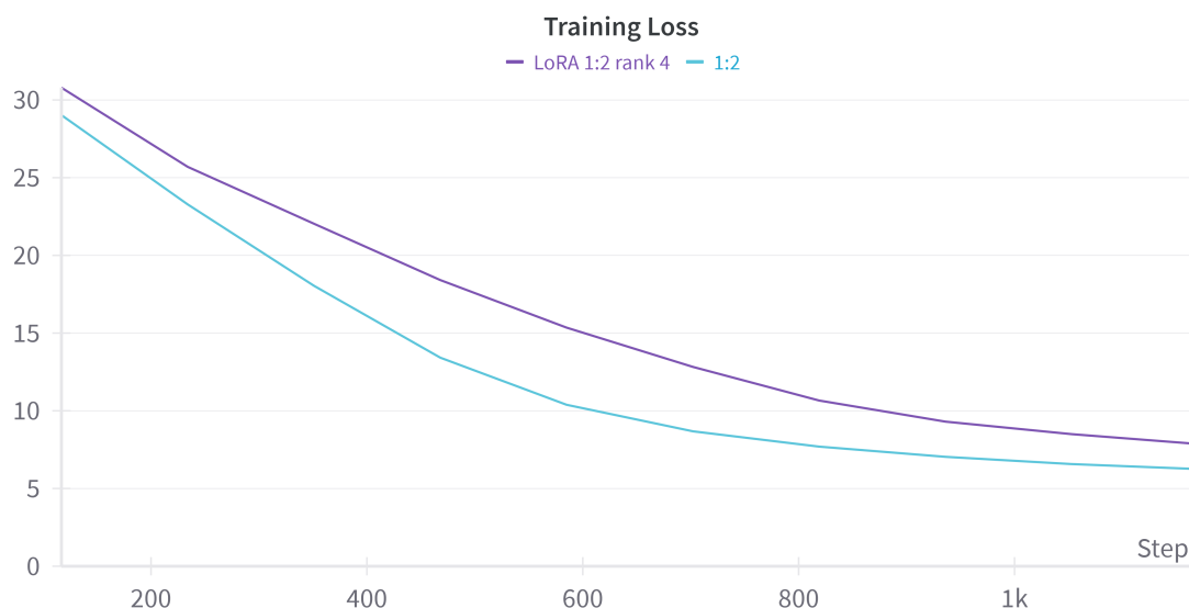
Obr. 8.13: Porovnanie priebehu chybovej funkcie pri trénovaní s použitím techniky LoRA a selektívneho zmrazenia modulov. Grafy ukazujú podobný priebeh konvergencie pre oba prístupy pri pomere nových a pôvodných dát 1:2.
