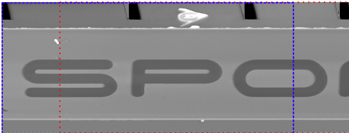
Obr. 3.1: Rozrezané podsnímky sa prekrývajú a majú spoločných 2000 pixelov na šírku.
