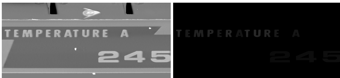
Obr. 7.1: Ukážka snímky a masky z dátovej sady pre semantickú segmentáciu modelu OneFormer.
