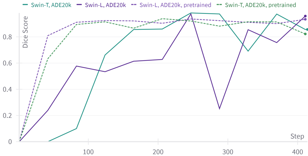
Obr. 8.2: Porovnanie výsledkov metrík Dice Score pri ponechaní pred trébovaných tried a nahradení modulov s novo inicializovanými váhami. Rozdiely pre jednotlivé verzie nie sú až tak výrazné, ale modely s novo inicializovanými váhami podávajú lepší výkon.
