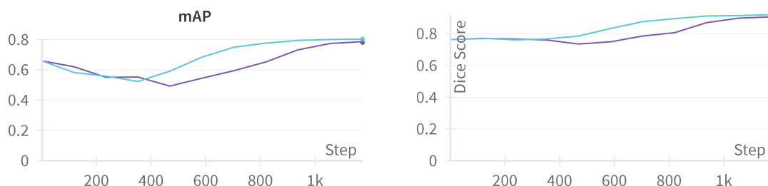
Obr. 8.14: Porovnanie metrík mAP a Dice Score pri trénovaní s použitím techniky LoRA a selektívneho zmrazenia modulov pri pomere nových a pôvodných dát 1:2. Z grafov vidno len malý rozdiel medzi týmito metódami.
