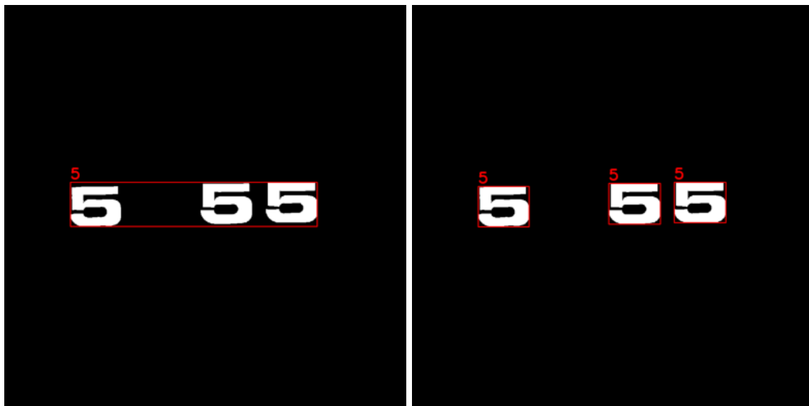
Obr. 8.5: Sémantická segmentácia nerozlišuje jednotlivé inštancie (vľavo) na rozdiel od panoptickej alebo inštančnej segmentácie (vpravo).
