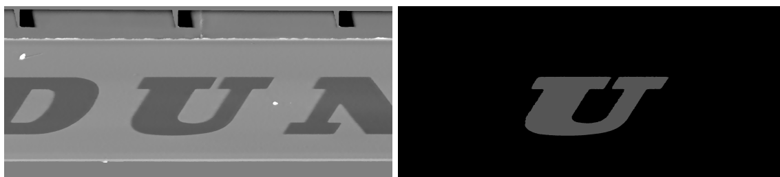
Obr. 3.2: Masky sú vytvorené len k symbolom, ktoré sú na snímke prítomné z väčšej časti ako určený prah (v tomto prípade 95%).
