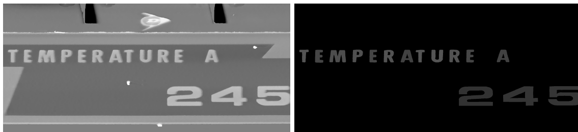
Obr. 2.2: Snímka vytvorená z 3D skenu bočnice pneumatiky a korešpondujúca maska so symbolmi.
