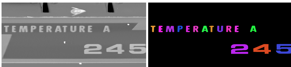
Obr. 7.2: Ukážka snímky a masky z dátovej sady pre panoptickú segmentáciu. Inštancie patriace do rovnakej triedy majú podobné farby (napríklad trieda „A“)
