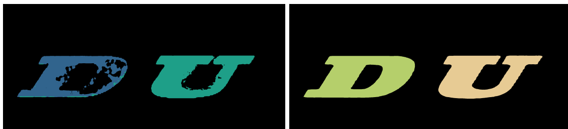
Obr. 8.6: Nekvalitné a necelistvé masky pre veľké symboly, ktoré sú výstupom modelu trénovaného na sémantickej segmentácii (vľavo) a na porovnanie výstup inštančnej segmentácie (vpravo).
