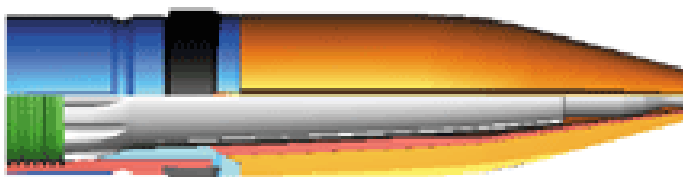
Obr.10.2.1. Superkavitační projektil RAMICS vyvinutý pro americké námořnictvo ve společnosti C Tech Defense. [3]
