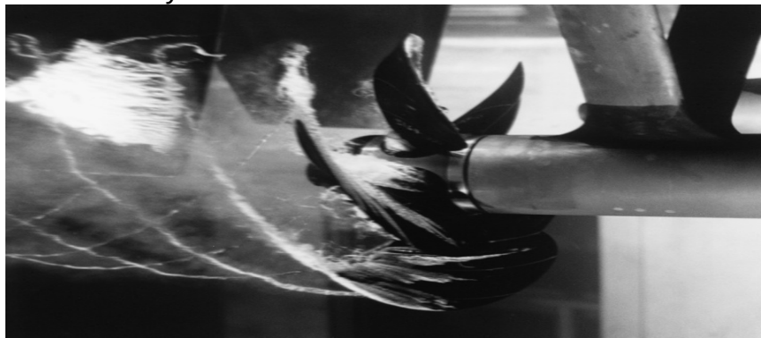
Obr.11.2. Kavítace na lopatkách lodního šroubu [10]
