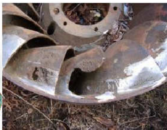
Obr. 9.3.2. Kavitací rozrušené lopatky rotoru Francisovi turbíny [10]
