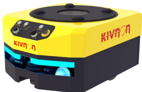
Obr. 40 Mobilní robot K03 s otočným stolem, firma Kivnon, upraveno dle [70]
