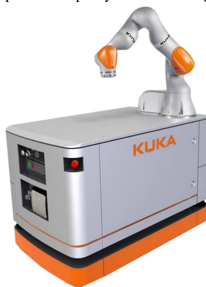
Obr. 43 Vozík iiva s manipulační rukou, firma KUKA, upraveno dle [72]
