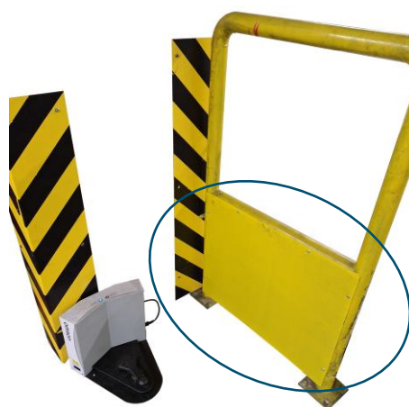
Obr. 89 Zábrany LiDARu [autor]
