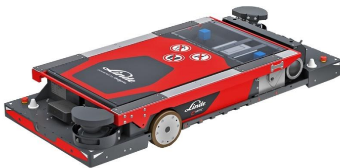
Obr. 45 AMR společnosti Linde: C-MATIC HP 10, [74]
