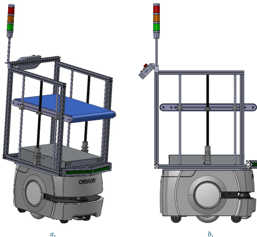
Obr. 68 Koncepční návrh varianty provedení s kuličkovým šroubem a maticí [autor]
