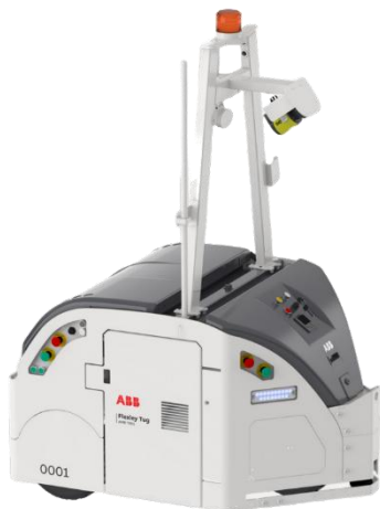
Obr. 26 Tahač ABB AMR T901, upraveno dle [59]
