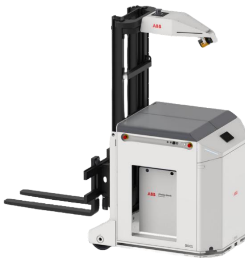
Obr. 27 Paletový vozík ABB AMR F702, upraveno dle [59]
