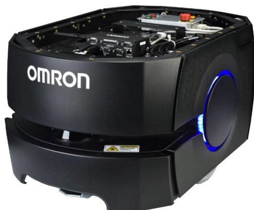
Obr. 47 LD-60 ve verzi ESD společnosti OMRON, [76]
