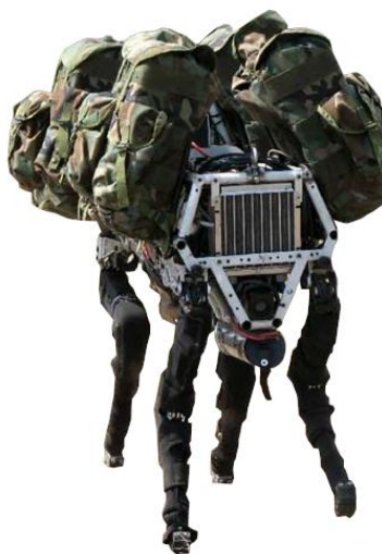
Obr. 5 Čtyřnohý robot BigDog, upraveno dle [154]
