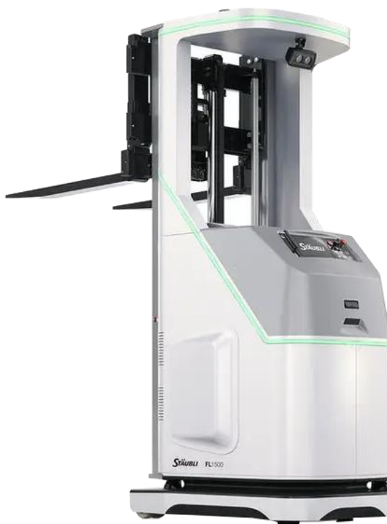
Obr. 54 Nadcházející vysoko zdvižný autonomní vozík FL1500 společnosti Stäubli, [84]
