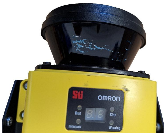
Obr. 96 LiDAR jednotka se zvýrazněným poškozením [autor]
