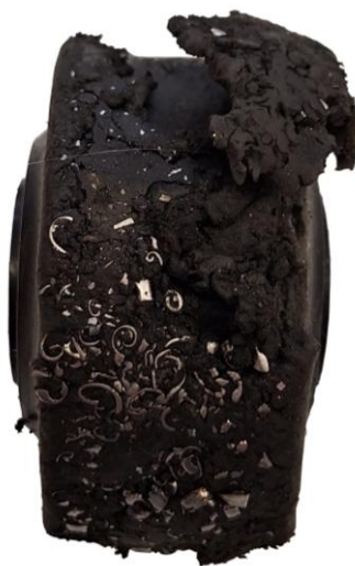
Obr. 97 Poškozené kolečko (nepoháněné) [autor]
