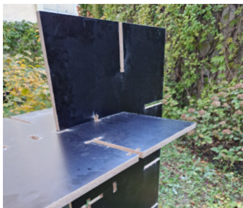
90 - projekt Skládačka, Betlém/ koledomat testování variant spojů 1:1, FA VUT, 2023 autor: Kristýna Smržová
