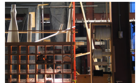
30 - snímek z dílny C.A.S.T., bednicí souprava vyvinutá pro výrobu prefabrikátů z tkaninových litých nosníků zdroj: The Architectural Review, Pedagogy: Centre for Architectural Structures and Technology, Canada
