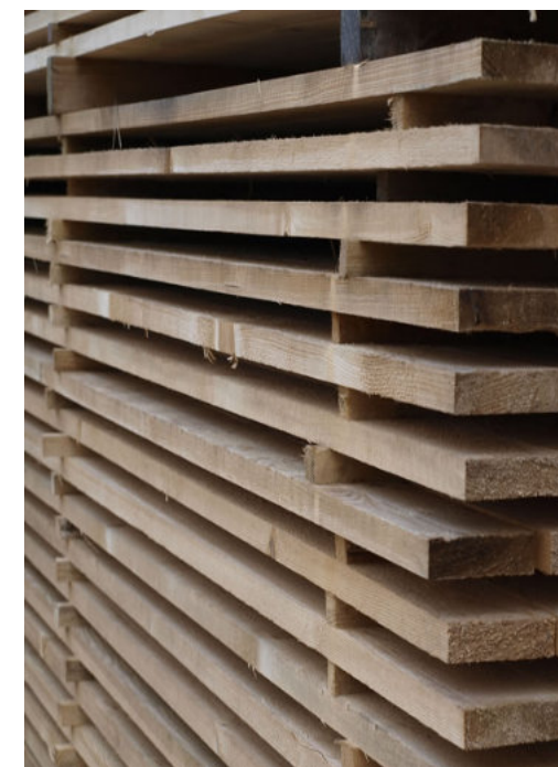
57 - adekvátní skladování dřeva s prokládkou zdroj: Palubky Koten
