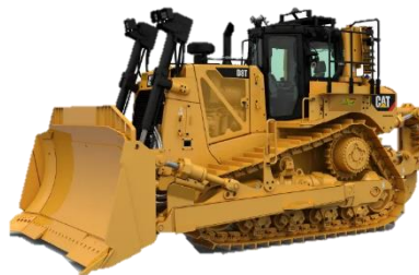
Obrázek č. 60: Dozer CAT D8T [47]
