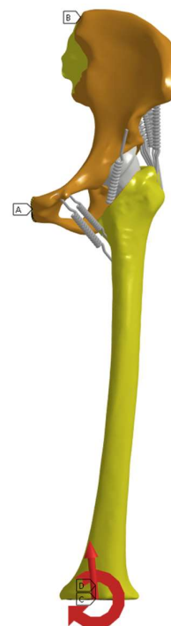
Obr. [31]: Okrajové podmienky aplikované vo výpočtových modeloch
