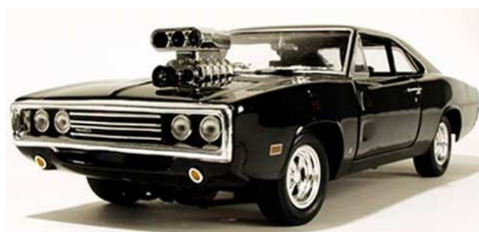
Obr. 25 - Dodge Charger R/T 1970: navíc přeplňovaný mohutným mechanicky poháněným dmychadlem Roots [16].
