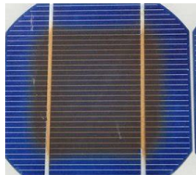
Obr. 2.6: Zbarvený FV článek
